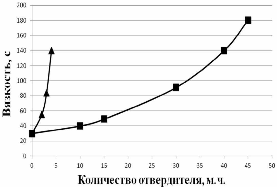
Рис. 1. Зависимость вязкости клея от количества и вида используемого наполнителя: ▲ – древесная мука, ■ – каолин
