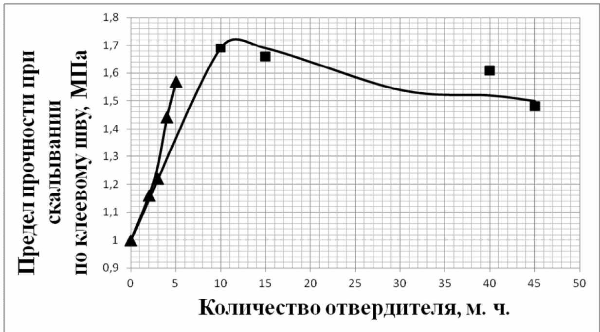
Рис. 2. Зависимость прочности склеивания от количества и вида используемого наполнителя: ▲ – древесная мука, ■ – каолин
