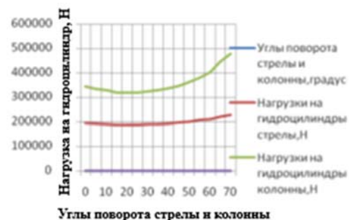
Рисунок 1. Нагрузки на гидроцилиндры привода колонны
