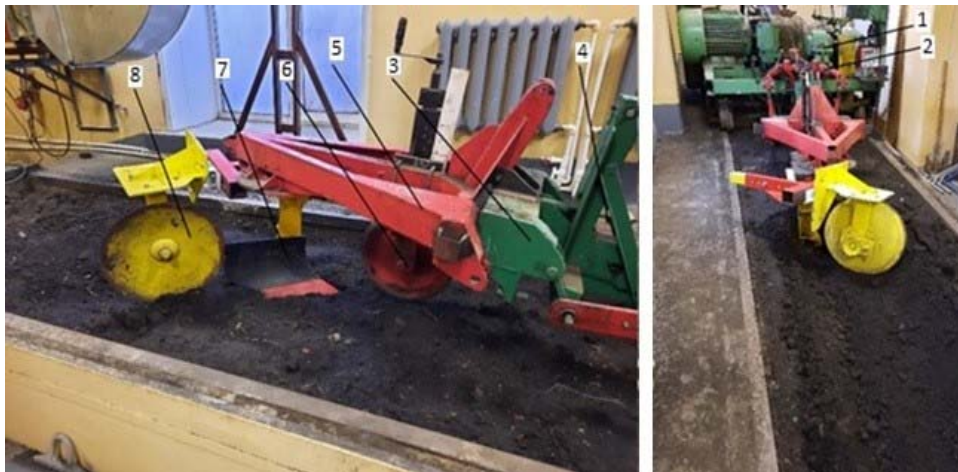
Рисунок 3. Установка для проведения лабораторных экспериментов по исследованию рабочего процесса лесного плуга / Figure 3. Apparatus for conducting laboratory experiments to study the forest plow working process
