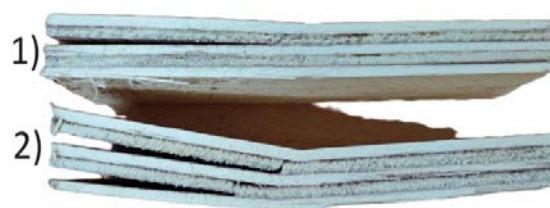
Рисунок 2. Характер разрушения образцов после проведения испытания на предел прочности при статическом изгибе: 1) контрольный образец; 2) образец, изготовленный по оптимальному режиму
