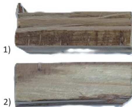
Рисунок 1. Характер разрушения образцов после проведения испытания на скалывание по клеевому слою: 1) – контрольный образец; 2) – образец, изготовленный по оптимальному режиму Figure 1. The nature of the destruction of the samples after the cleavage test on the adhesive layer: 1) – a control sample; 2) – a sample made according to the optimal mode
