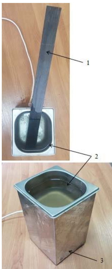
Рисунок 2. Установка ультразвуковой обработки: 1 – Образец 2 – Ванна 3 – Ультразвуковой излучатель Figure 2. Ultrasonic treatment unit: 1 – Sample 2 – Bath 3 – Ultrasonic emitter
