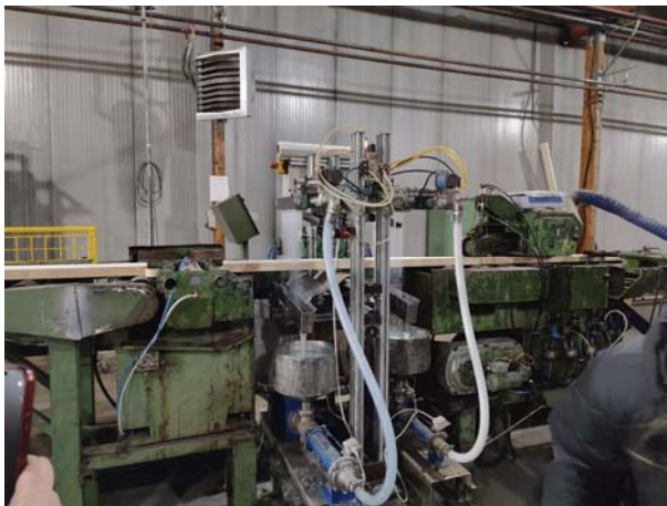
Рисунок 8. Участок автоматизированного нанесения клея и отвердителя
