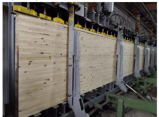
Рисунок 10. Запрессовка пакета ламелей гидравлическими домкратами
