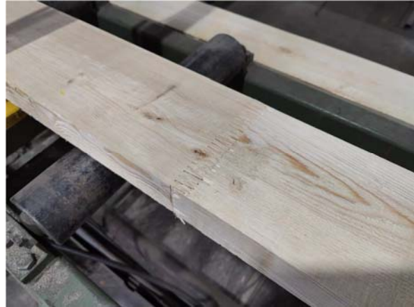
Рисунок 7. Шиповое соединение ламелей
