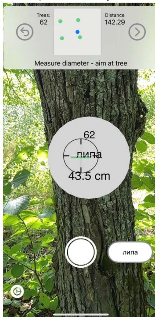
Рисунок 2. Интерфейс приложения Arboreal Forest в режиме измерения диаметров деревьев Figure 2. Arboreal Forest application interface in tree diameter measurement mode
