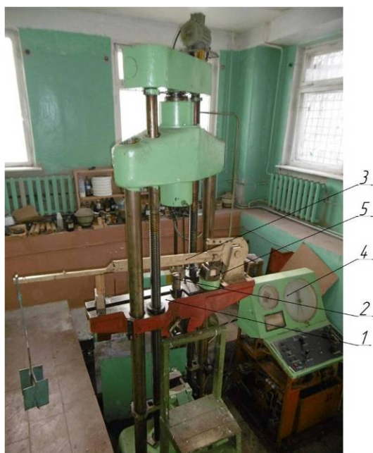
1 – опора; 2 – нагрузчитель; 3 – передатчик усилия (рычаг); 4 – пульт управления; 5 – обогреваемая прессформа с образцом древесины
