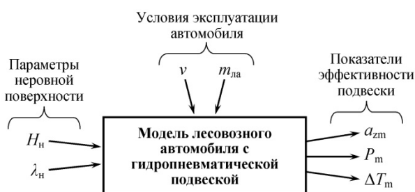
Рис. 5. Основные параметры модели лесовозного автомобиля с гидропневматической подвеской и рассчитываемые показатели эффективности (собственные разработки)
