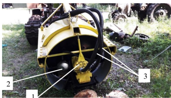
Рис. 2. Опытный образец лесопожарной грунтометательной машины 1 – гидромотор; 2 – пневмогидроаккумулятор; 3 – рукава высокого давления [собственные исследования]
