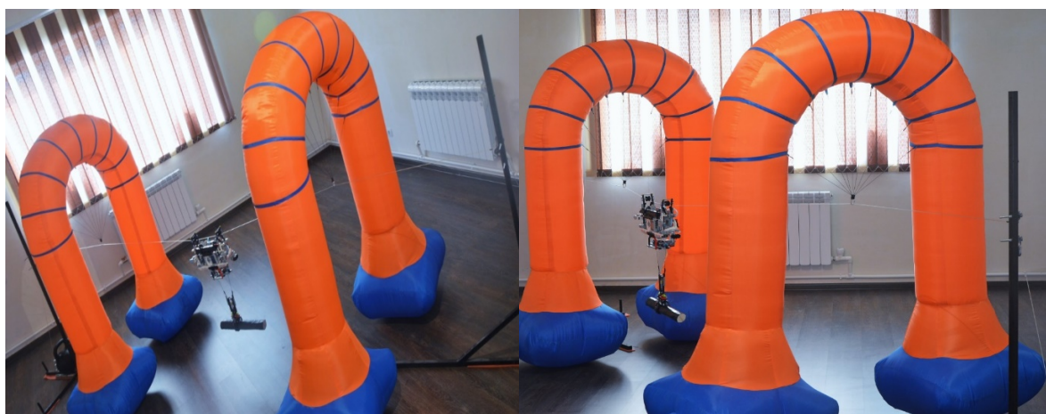
Рис. 4. Прототип экспериментальной модели канатного лесотранспортного комплекса на базе мягких пневматических конструкций
