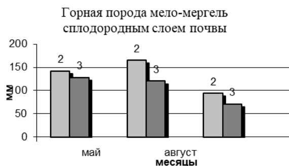
Рис. 2. Количество продуктивной влаги (мм) техногенных почв в метровом слое за вегетационный период 2015 г.: 1 – горная порода меломергель – контрольный вариант; 2 – техноземная почва: горная порода меломергель с мелиоративным слоем 10 см; 3 – техноземная почва: горная порода меломергель с мелиоративным слоем 20 см; 4 – техноземная почва: горная порода меломергель с мелиоративным слоем 50 см
