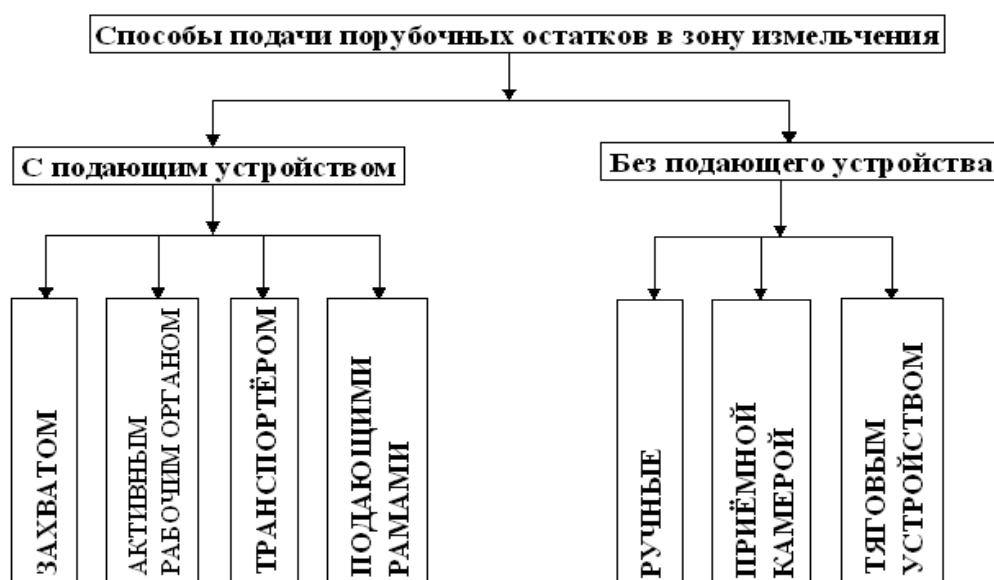
Рис. 1. Классификация способов подачи порубочных остатков в зону измельчения
