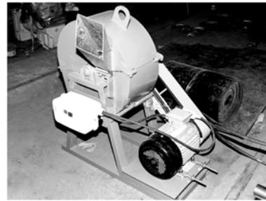
Рисунок 10. Роторно-молотковая щепорубилка
