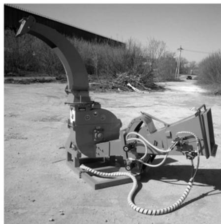
Рисунок 7. Измельчитель с гидropодачей навесной ИВН-1Г
