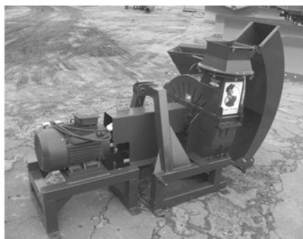
Рис. 8. Измельчитель веток дерева С52ИВН (с электроприводом)
