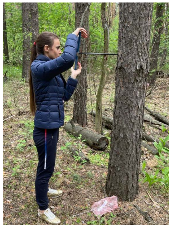
Рис. 1. Взятие возрастным буравом керна древесины на высоте 1,3 м у модельного дерева № 3 на ВПП № 8-20
