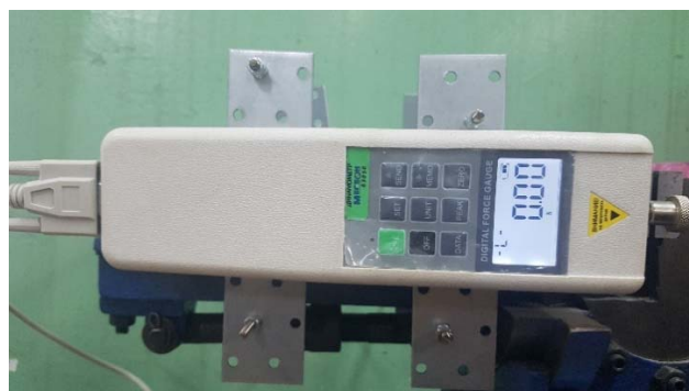
Рисунок 5. Внешний вид цифрового динамометра, измерителя амплитудных значений изгибных колебаний
