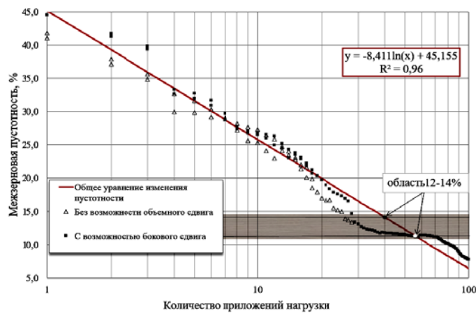
Рис. 2. Изменение межзерновой пустотности в зависимости от количества приложений нагрузки для низкопрочного известнякового щебня марки 400
