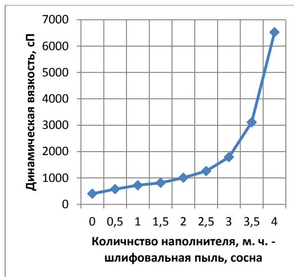
Рис. 4. Зависимость динамической вязкости наполненных клеев от количества наполнителя
