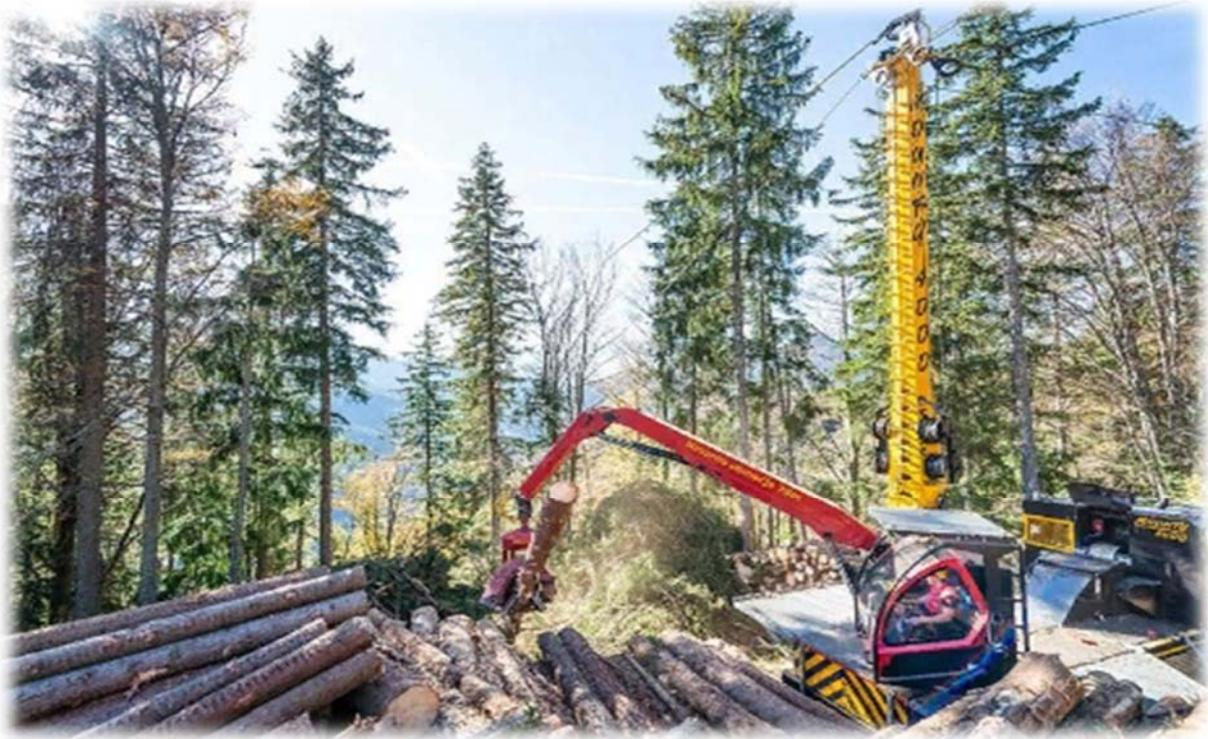
Рисунок 1. Машина Mounty 4000 с процессорной головкой WoodyH60
