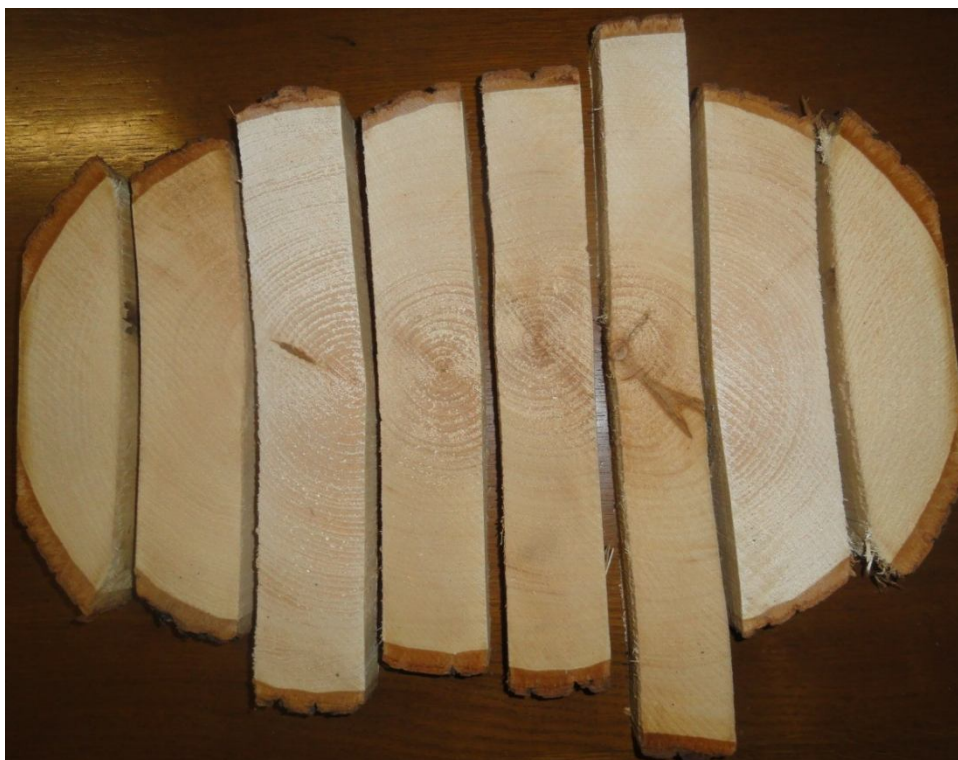
Рисунок. Образцы поперечного раскроя липовых необрезных сердцевинных, центральных и боковых досок
