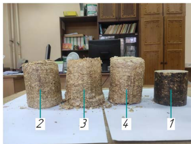
Рисунок 7. Изменение высоты брикетов при хранении: 1 – 5 мин; 2 – 0,5 ч; 3 – 2 ч; 4 – 24 ч (брикеты получены при влажности 10 %, температуре 80 °С, времени выдержки в матрице 12 мин)
