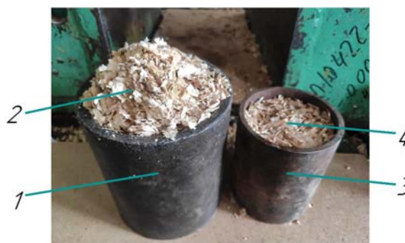
Рисунок 4. Прессующий конус и матрица с древесиной: 1 – конус; 2 – щепа; 3 – матрица; 4 – прессованный брикет
